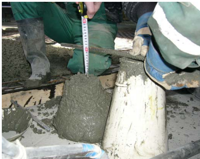
Рис. 14. Схема проверки подвижности бетонной смеси по осадке конуса
