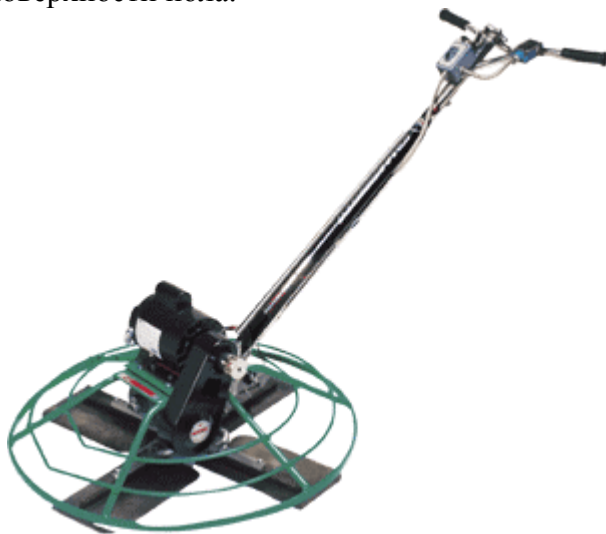
Рис. 5. Однороторная электрическая бетоноотделочная машина с диаметром диска 60 см для затирки в местах примыканий.
